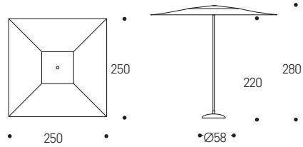
Struttura in alluminio verniciato a polveri completo di tendaggio in poliestere. Base rotonda in cemento e sistema di apertura a carrucola.
