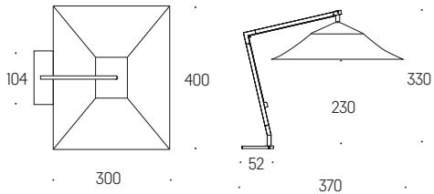
Struttura in alluminio anodizzato ed acciaio 304 EP completo di 2 basi, tendaggio in acrilico e di sacco di copertura. Rotazione 360°. Aluminum and stainless steel 304 EP structure with 2 bases complete with acrylic fabric and bag cover. 360° rotation.
